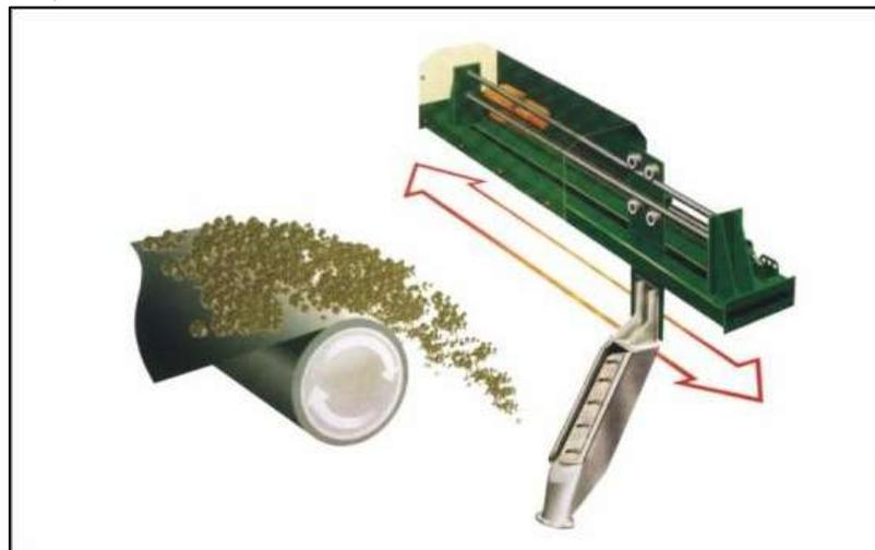
Figura 2 - Amostrador de trajetória retilínea, montado na extremidade de um transportador de correia. Fonte: [www.engendrar.com.br](http://www.engendrar.com.br)
