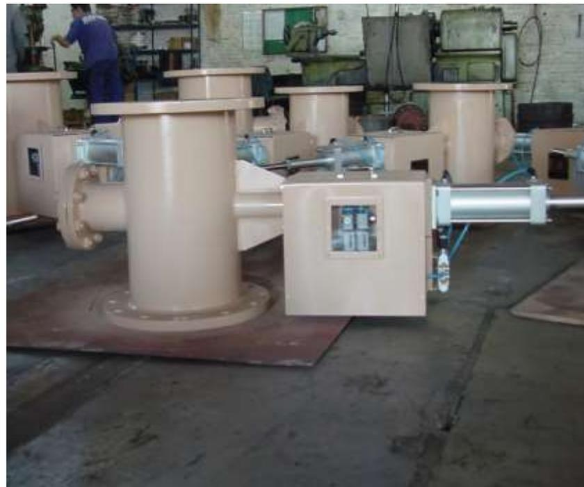
Figura 5 - Amostrador pneumático para duto. Fonte: [www.engendrar.com.br](http://www.engendrar.com.br)
